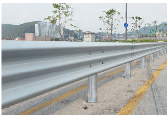
중량분리대용 SB4등급 [JD-SC-SB4-A] / W2000 x H860 (mm)
